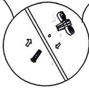
**ВНИМАНИЕ!** Ручку крепить к передней стенке ящика винтом 4x12, затем крепить переднюю стенку ящика к блоку ящика стяжками эксцентриковыми
